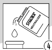
Шаг 4 - Нейтрализация кислотности теплообменника
