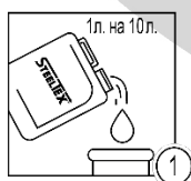
Шаг 1 - Приготовление промывочного раствора
