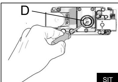
Поверните винт регулировки минимального расхода газа (D) по часовой стрелке, чтобы увеличить значение CO<sub>2</sub>. Если вы повернете его против часовой стрелки, расход газа уменьшится и, следовательно, количество CO<sub>2</sub> тоже уменьшится.
