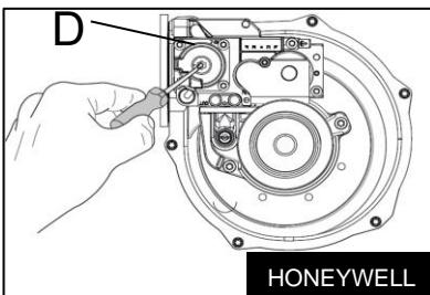
Настройка выбросов при минимальной нагрузке производится путем измерения содержания CO<sub>2</sub> в дымовых газах. Чтобы принудительно перевести котел на минимальную мощность необходимо выполнить следующие шаги.
