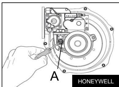
Поворачивайте винт регулировки объема подаваемого газа в номинальном режиме (A) по часовой стрелке для увеличения значения CO<sub>2</sub>. Если поворачивать этот винт против часовой стрелки, то расход газа будет уменьшаться и, таким образом, будет уменьшаться и значение уровня CO<sub>2</sub>.
