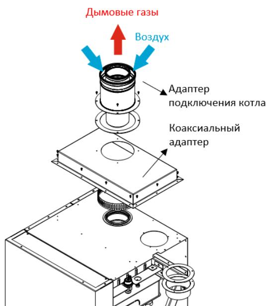
Если необходимо использовать соединение дымохода типа В23, следует использовать переходник для всасывания чистого воздуха, а отработанный газ следует отводить во внешнюю среду через трубу Ø100 мм.
