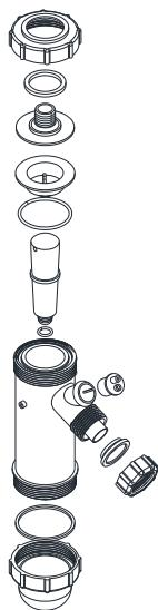
Конденсат, образующийся в процессе сгорания, сливается в систему канализации через сифон и дренажный шланг. Подключение дренажного шланга к системе канализации должно быть выполнено с созданием постоянного уклона и разрывом потока. В качестве альтернативы подключить сливной шланг к устройству нейтрализации конденсата.
